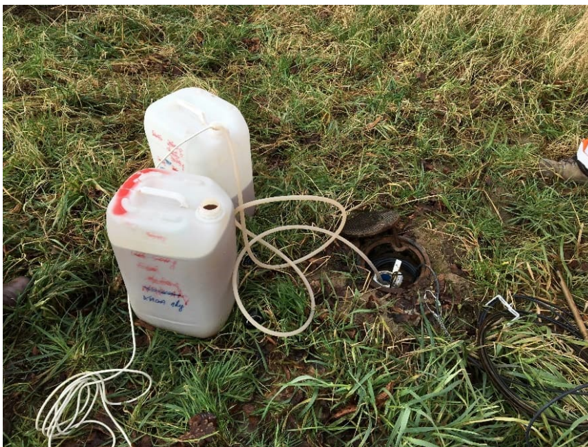
Photo 12: Injection de la sulforhodamine G dans le forage F2 en amont du forage "Schwartz"
