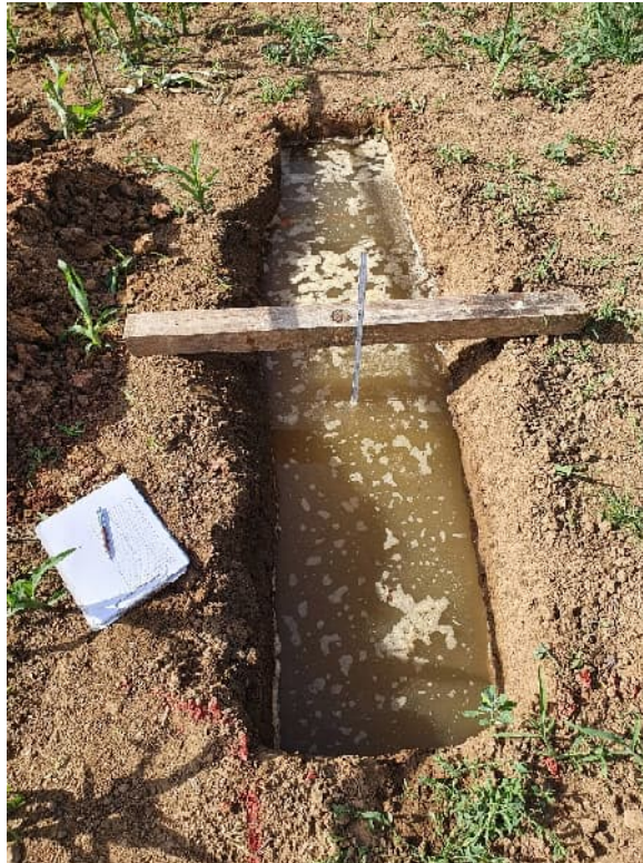
Photo 17: Remplissage de la fouille avec installation de mesure de l'évolution du niveau d'eau (fouille de "Mierscherbiere")
