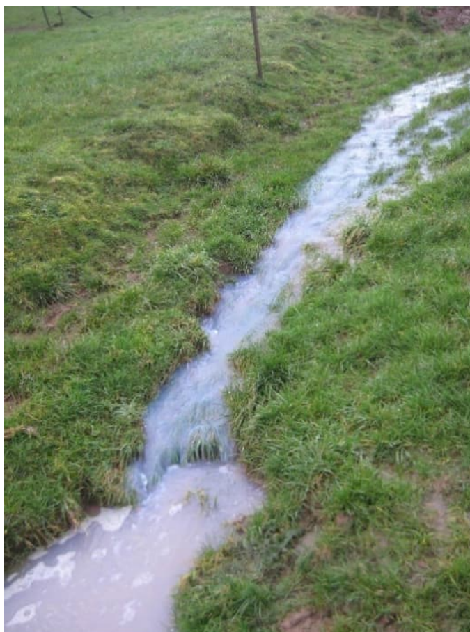
Photo 15: Injection de traceur dans les eaux superficielles du vallon de "Kuelereech", en amont du forage "Schwartz"
