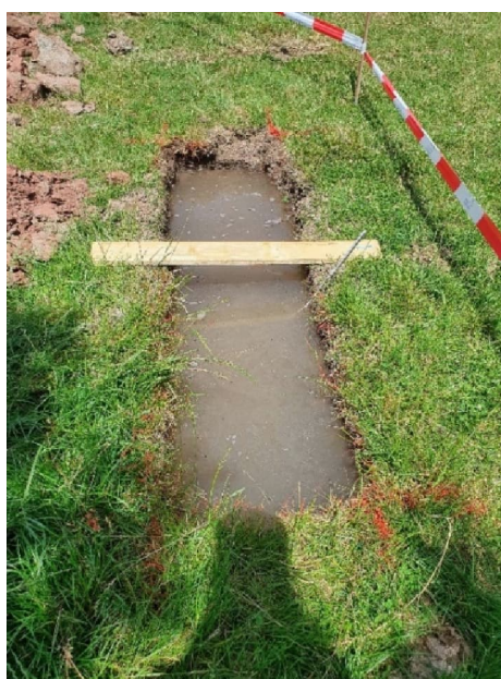
Photo 22: Fouille réalisée dans le vallon du "Wëllerbaach", dans les dépôts alluvionnaires qui recouvrent le fond de vallée
